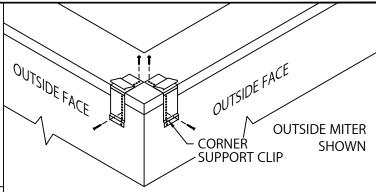
STEP 1 - CORNER SUPPORT CLIPS LOCATE AND FASTEN THRU GALVANIZED CORNER SUPPORT CLIP TO THE WALL AS SHOWN. FOR FASTENER DETAIL SEE PAGE 4.
